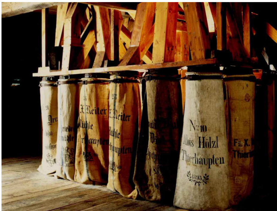
Sackbank zum Abfüllen von Mahlgut
